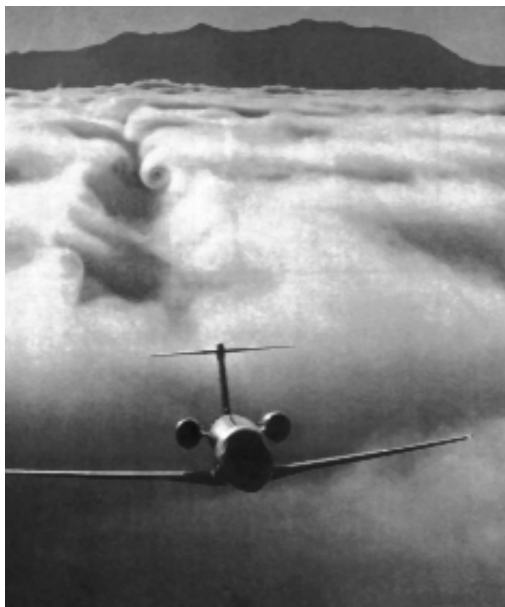
Fig. 13: Deflessione (macchia scura subito dietro l'ala) e vortici d'estremità (in lontananza), dietro un bireattore che vola nella nebbia. Sembra che i vortici non abbiano alcuna intenzione di precipitarsi a terra.
